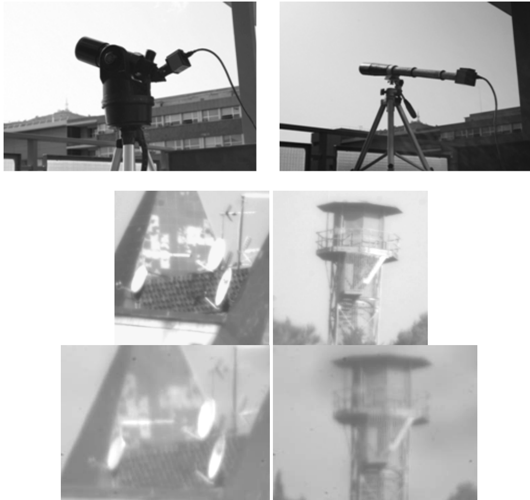
Fig. 9. Superior esquerra: Telescopi modern amb la càmera CCD connectada per obtenir les imatges perfectes. Superior dreta: Càmera CCD connectada a la ullera de llarga vista per obtenir imatges experimentals. Inferiors: Imatges resultants.
